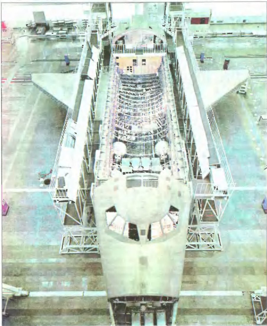
Советский космический корабль «Буран», двоюродный брат американского «Шаттла», в сборочном цехе перед установкой «рассекреченных» плиток теплозащиты
